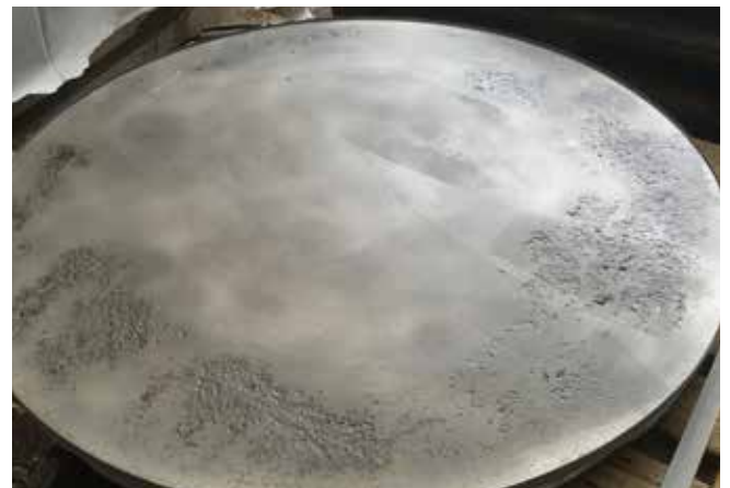
Tampa de tanque de água do mar WEICON Uretano 85
