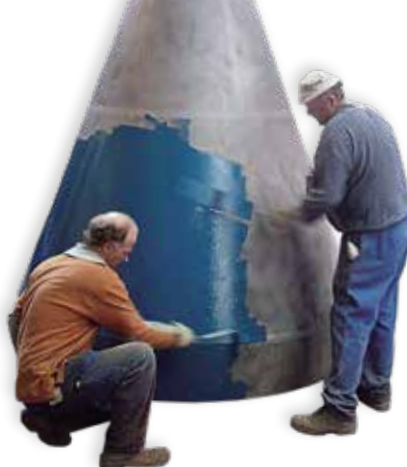
Revestimento de uma peça de uma máquina WEICON Cerâmico BL
