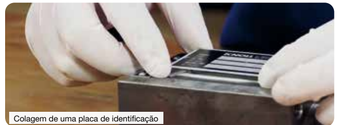
Colagem de uma placa de identificação
